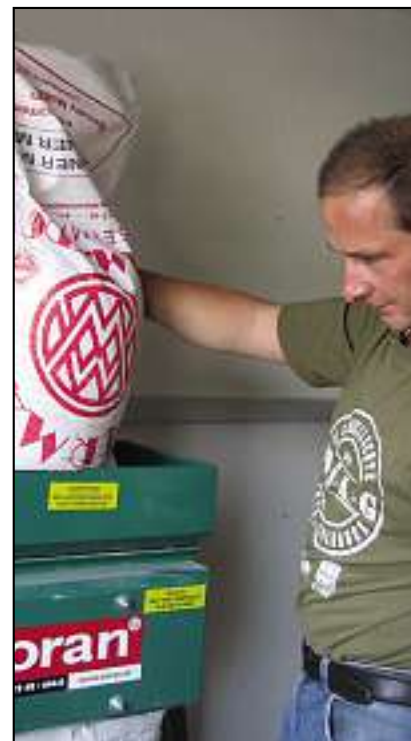
Das Malz wird mit einer Schrotmühle zerkleinert (geschrotet), um die spätere Lösung der darin enthaltenen Stoffe im Brauwasser zu erleichtern.
