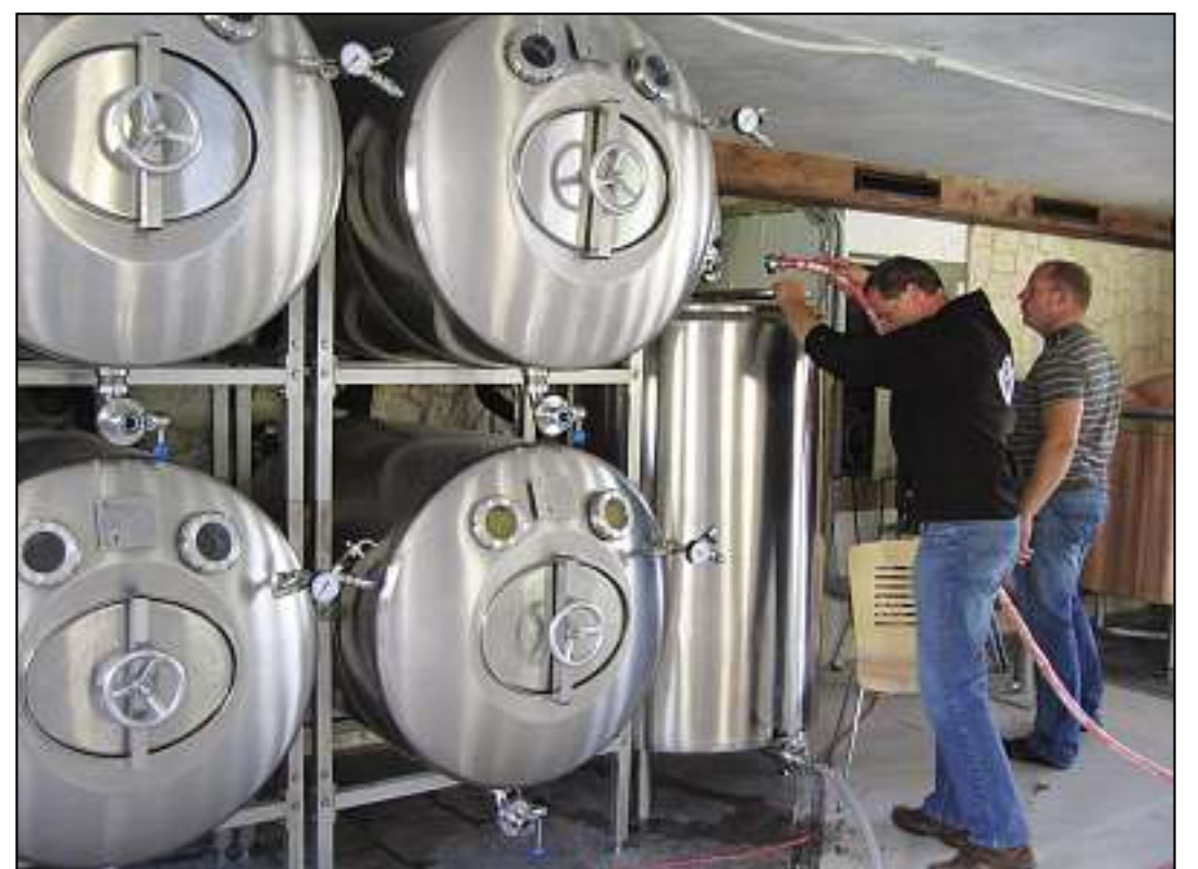
Nach zwei bis drei Tagen im Gärntank wird das Bier in die Lagertanks umgepumpt. Nun muss der Gärntank gereinigt werden.
